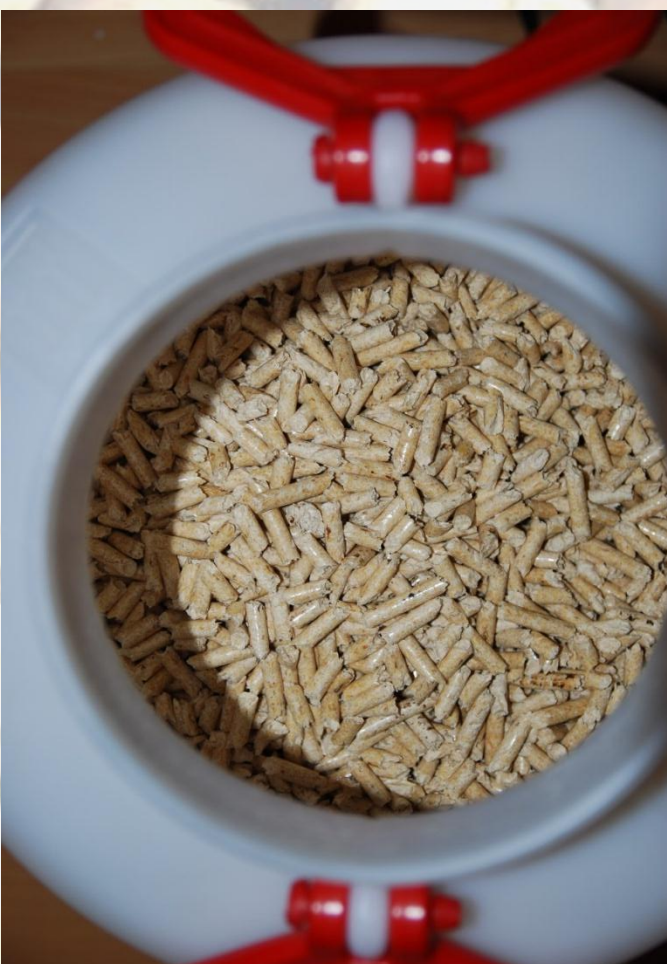
Abb. 1: 25 Liter Polypropylenbehälter gefüllt mit 12 kg handelsüblicher Pellets für Versuchsreihe 1.
