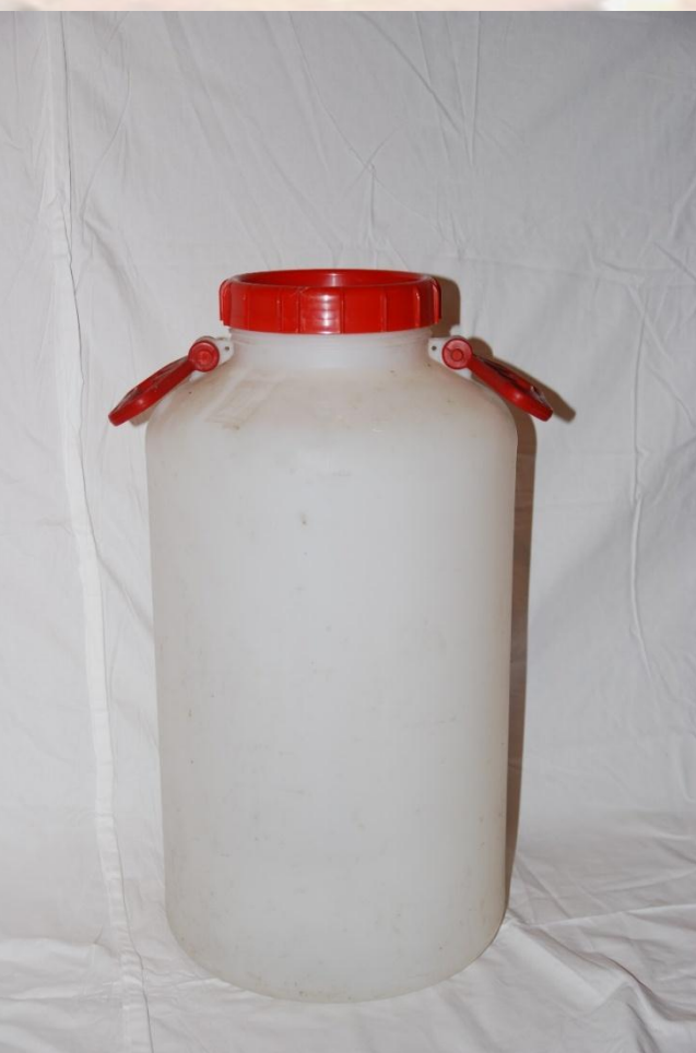
Abb. 1: 25 Liter Polypropylenbehälter gefüllt mit 12 kg handelsüblicher Pellets für Versuchsreihe 1.
