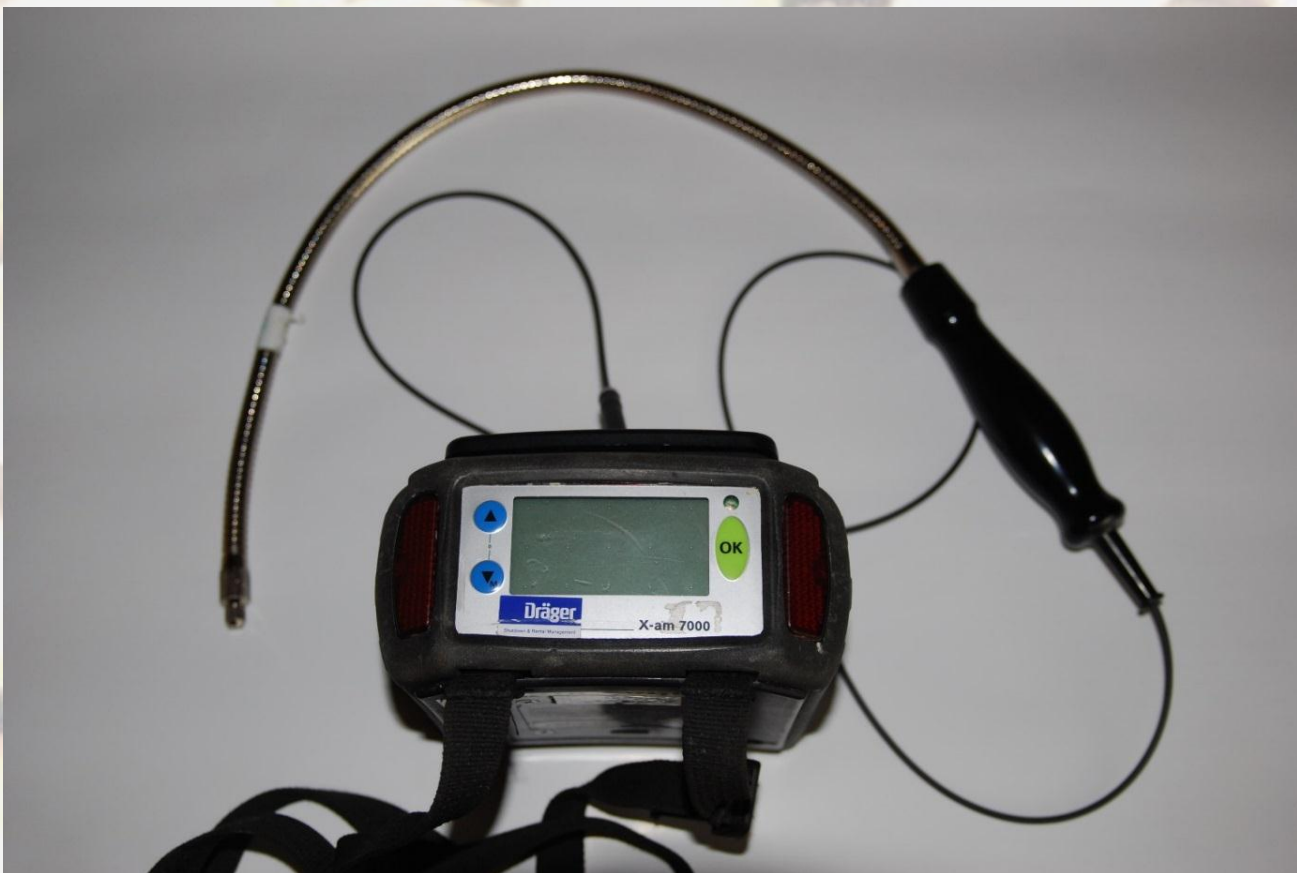
Abb. 4: Gasprobenahmeausstattung, Dräger X-AM 7000 mit Zusatzausstattung
